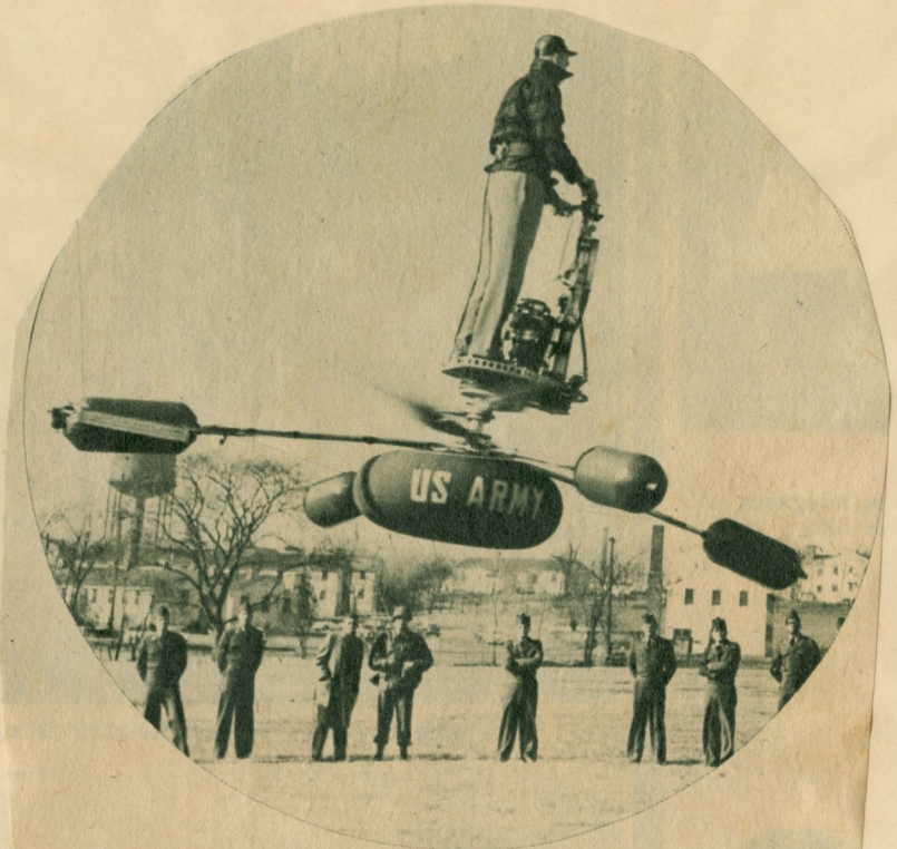
Entienden los expertos aeronáuticos que el helicóptero individual para uso civil será realidad en poco tiempo. Este modelo, llamado "heliciclo", es ensayado por el ejército norteamericano como medio de dar mayor movilidad a la infantería.
