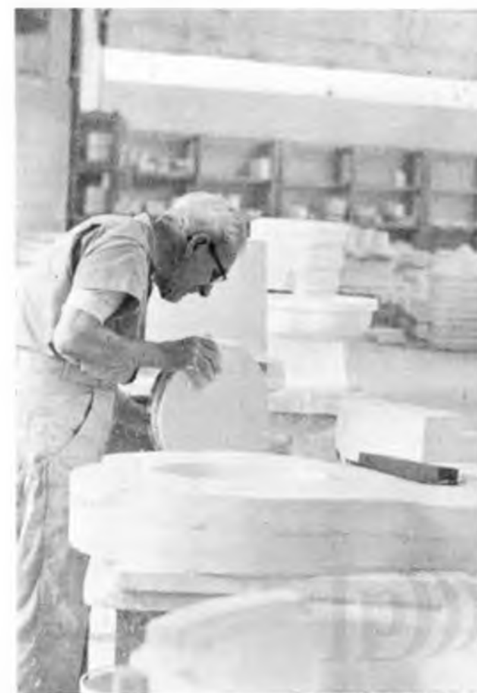
OBRREROS YESISTAS ESPECIALIZADOS TIENEN A SU CARGO LA FABRICACION DE LOS "MOLDES". DE ESTE PRIMER PASO DEPENDERA LA CALIDAD.
