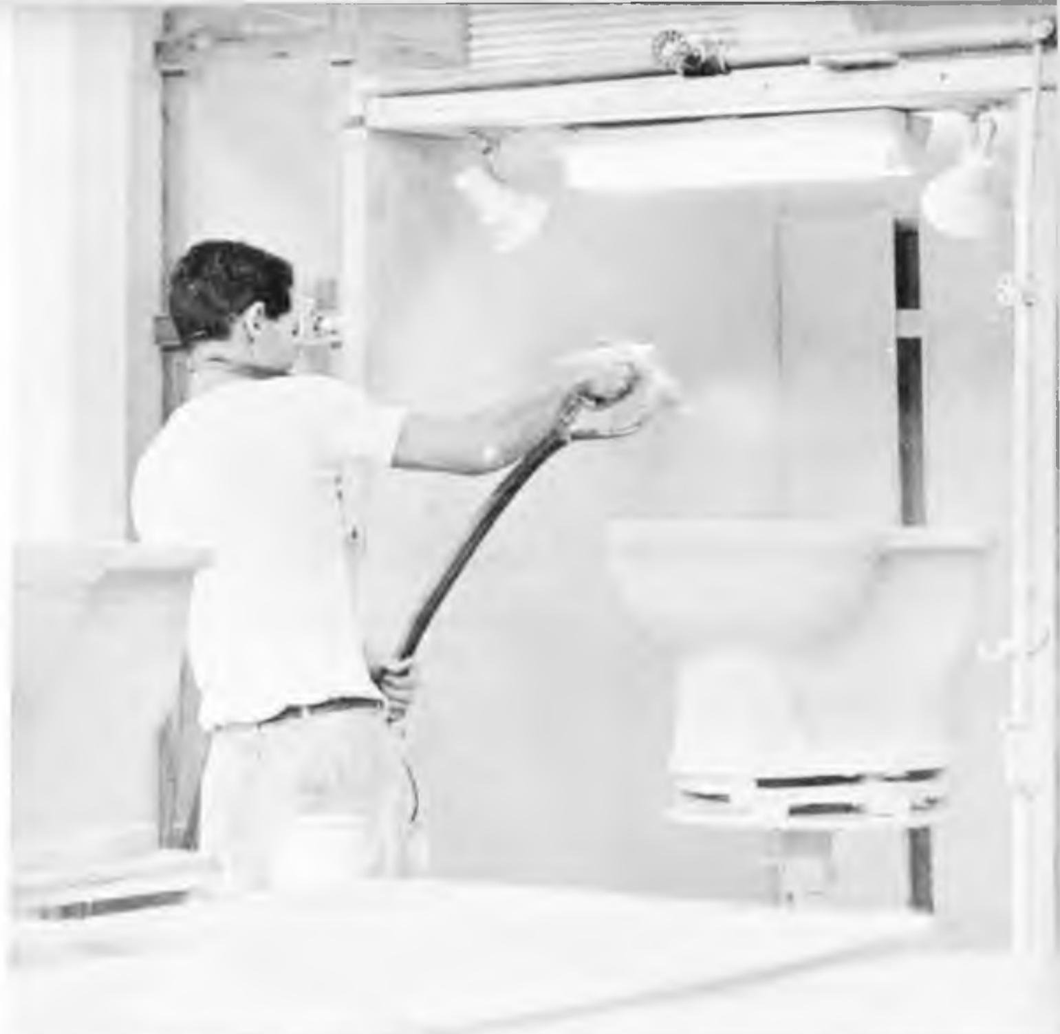
EL ESMALTE DE LAS PIEZAS SANITARIAS ES UN DELICADO PROCESO QUE REQUIERE GRAN DESTREZA; CUALQUIER DEFICIENCIA PUEDE OCASIONAR LA PERDIDA DE LA PIEZA AL HORNEARSE.
