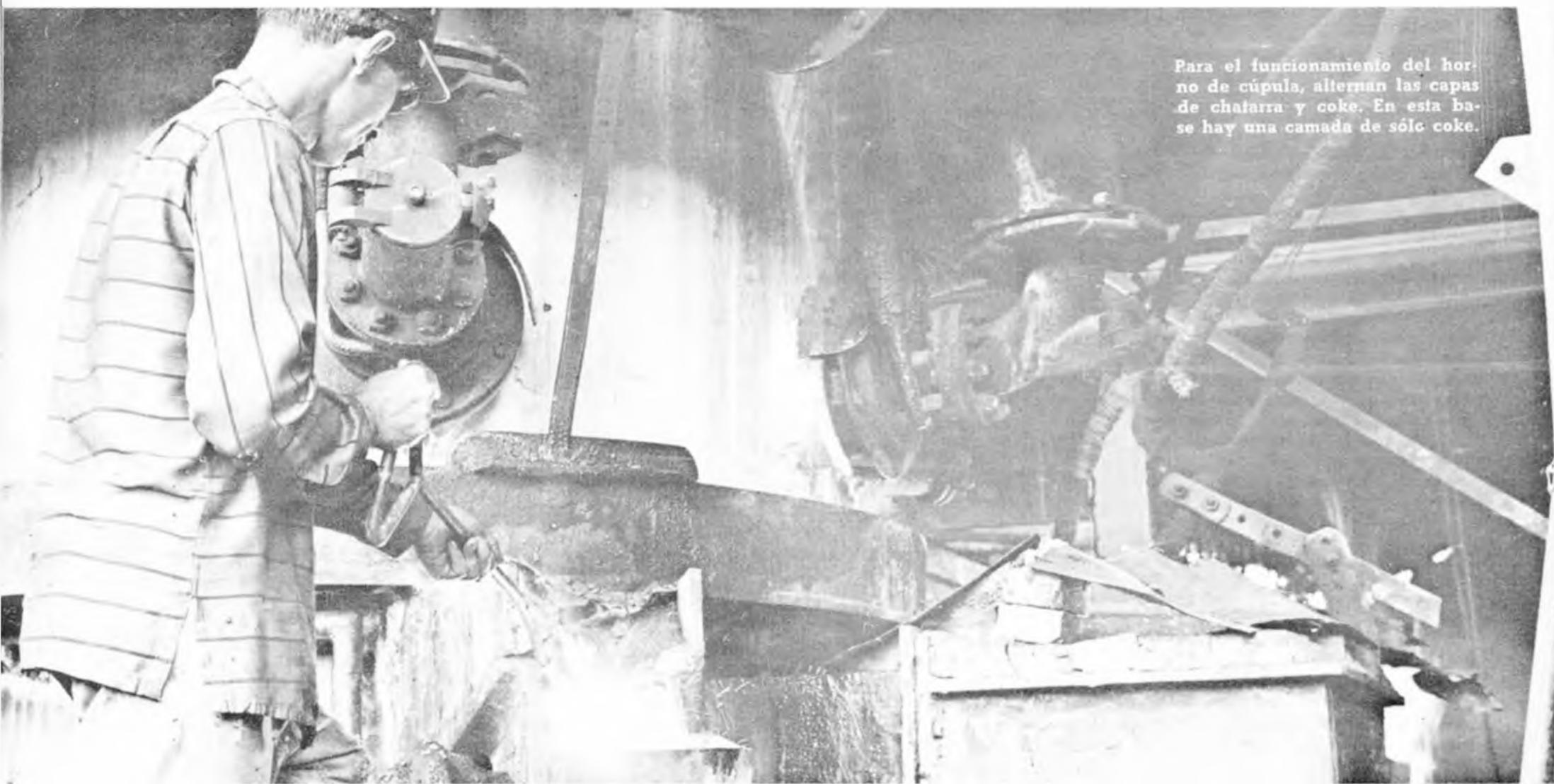
Para el funcionamiento del horno de cúpula, alternan las capas de chatarra y coke. En esta base hay una camada de sólido coke.
